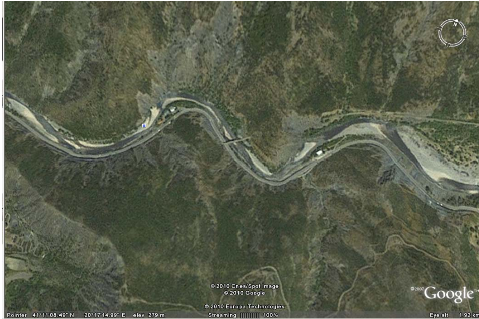
Foto 18. Skarpata më të pjerrëta sesa lejon fortësia e shkëmbinjve serpentinitë në rrugën Elbasan-Librazhd, ku ka rrënie gurrësh në trasenë e rrugës gjatë shirave
